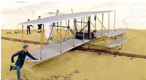
Конструкция, предложенная братьями Райт была мало похожа на современные самолеты, но винт был сзади
